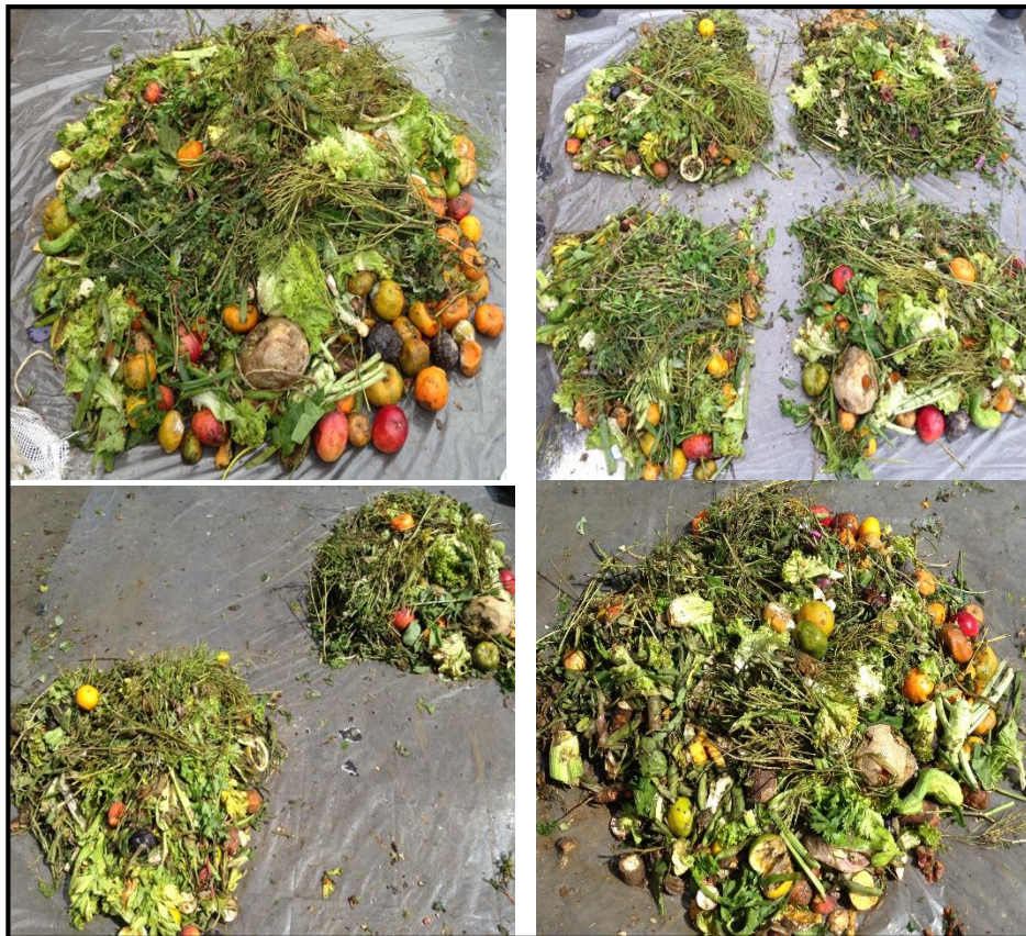
Ilustración 6. Método de cuarteo.
