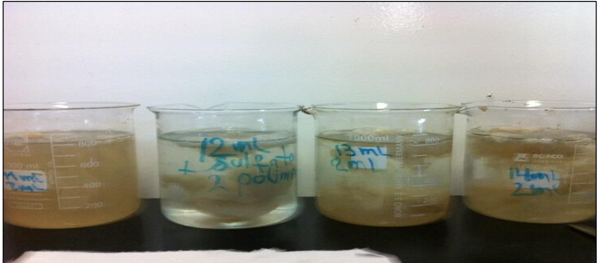
Figura 13. Resultados primer test de jarras floculante L-1648, 2 mL (200 ppm).
