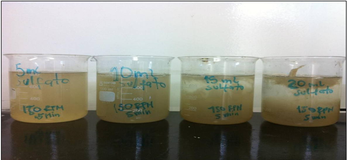
Figura 12. Resultados coagulación Sulfato de Aluminio.
