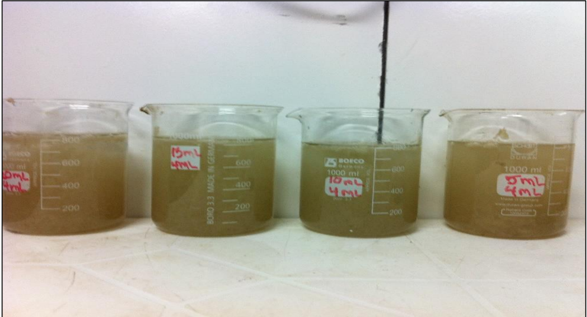
Figura 15. Resultados tercer test de jarras floculante L-1648, 4 mL (400 ppm).
