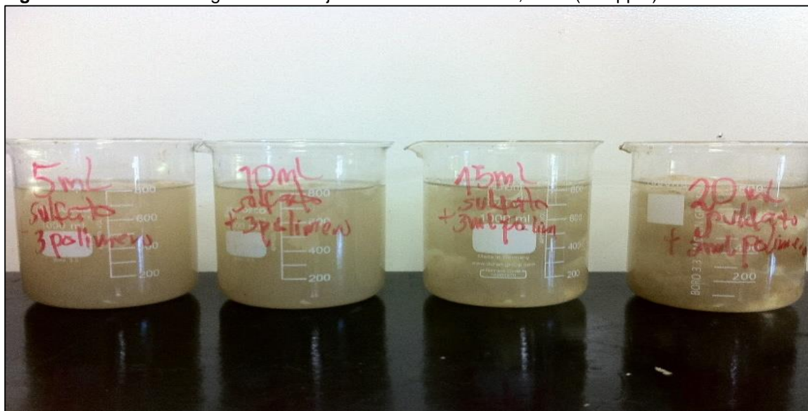
Figura 14. Resultados segundo test de jarras floculante L-1648, 3 mL (300 ppm).
