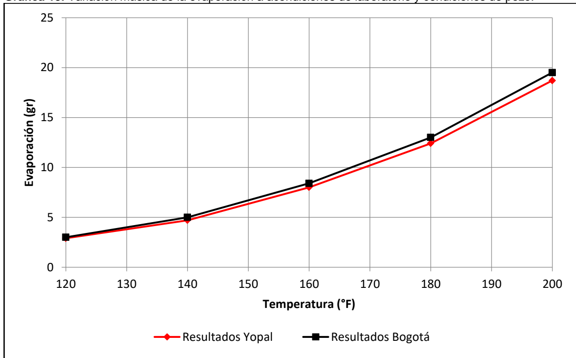
Gráfica 13. Variación másica de la evaporación a condiciones de laboratorio y condiciones de pozo.
