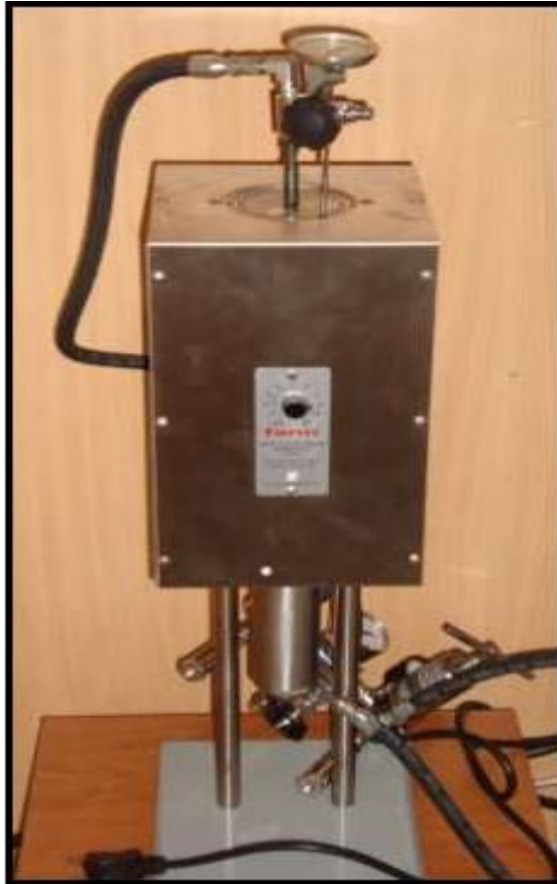
Figura 29. Filtroprensa utilizada para el fluid loss.
