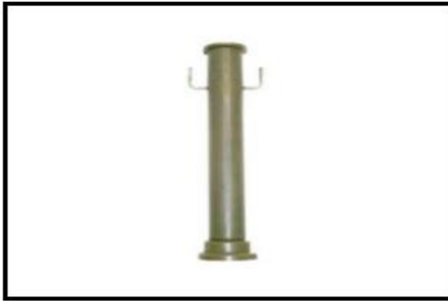
Figura 38. Molde para la prueba de sedimentación.
