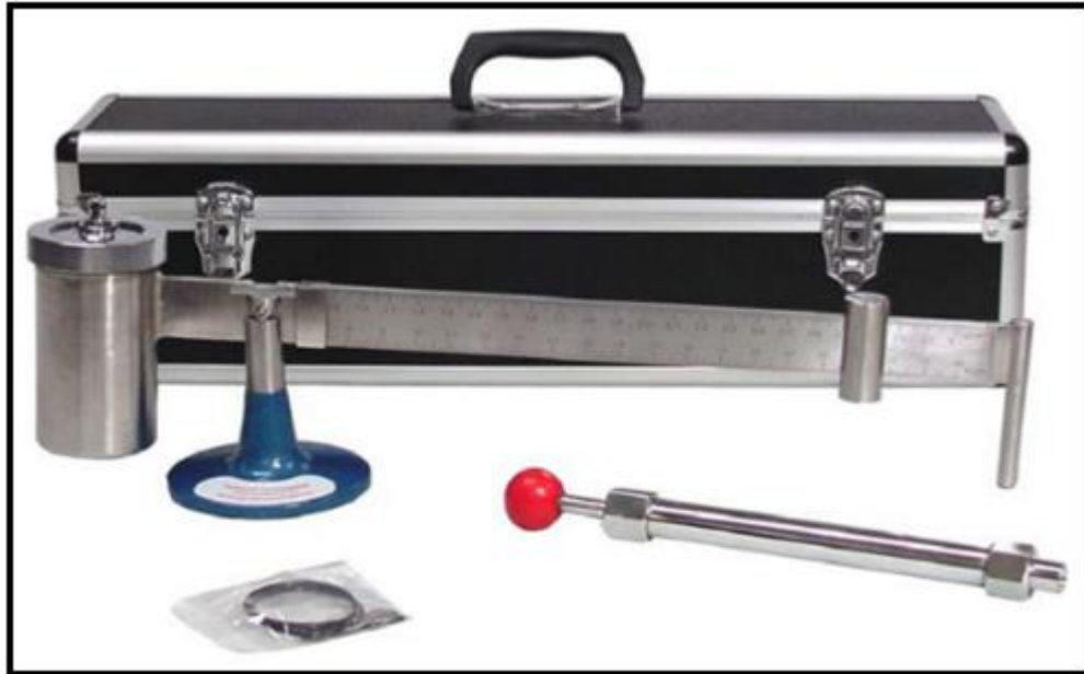
Figura 25. Balanza presurizada con sus partes
