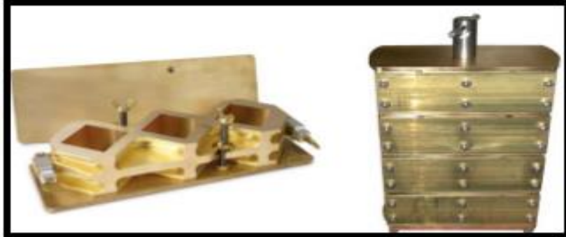
Figura 34. Moldes de 2" x 2" para las muestras, ensayo destructivo.
