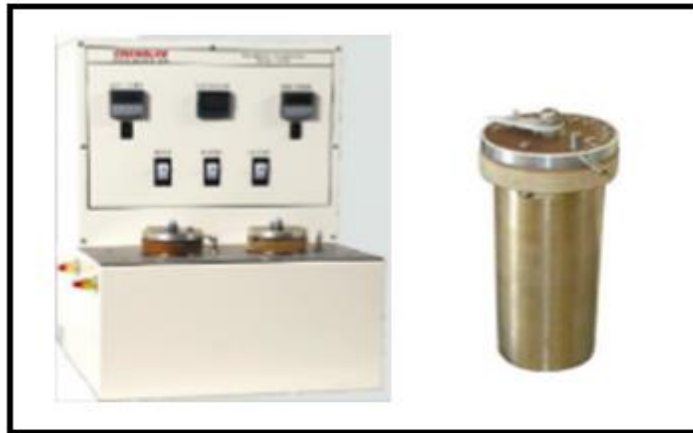
Figura 26. Consistómetro atmosférico y su copa de acondicionamiento.
