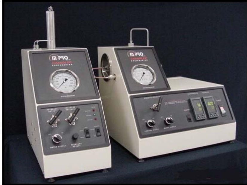
Figura 36. MPRO o analizador de propiedades mecánicas.
