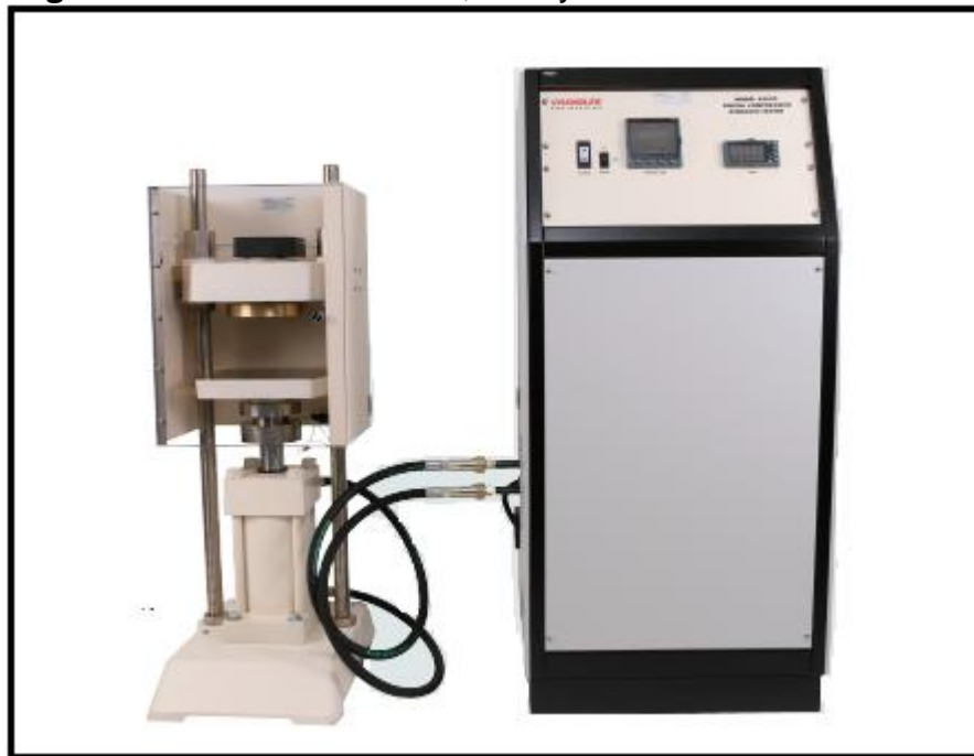
Figura 35. Prensa hidráulica, ensayo destructivo.
