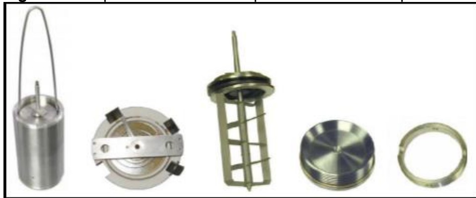
Figura 31. Copa del consistómetro presurizado con sus partes.
