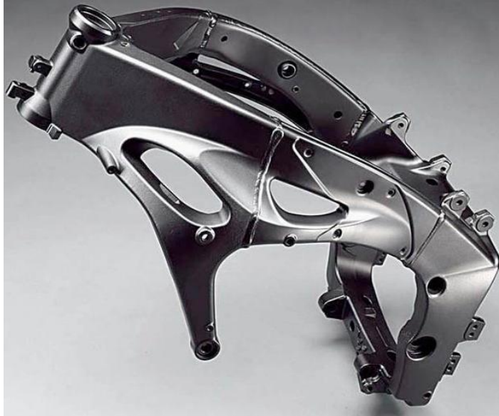
Imagen 37. Chasis doble viga o perimetral.
