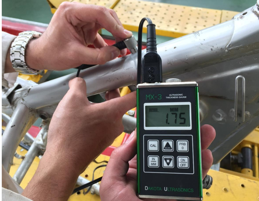
Imagen 42. Toma de espesores con ultrasonido
