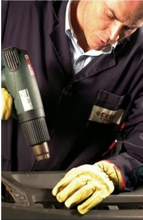
Imagen 29. Reparación de plástico por conformado
