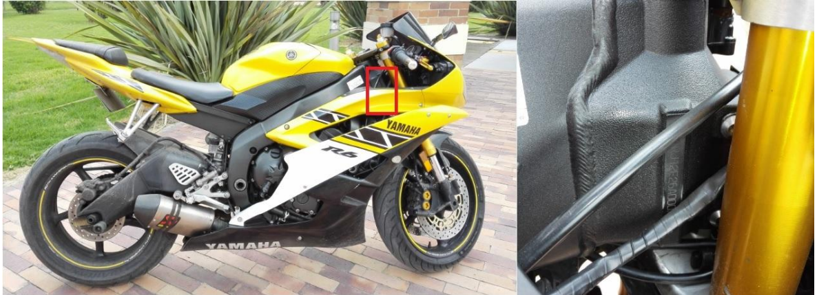
Imagen 11. Ubicación del número VIN en el chasis
