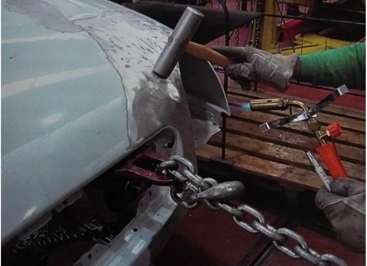
Imagen 23. Atemperado de una chapa de aluminio
