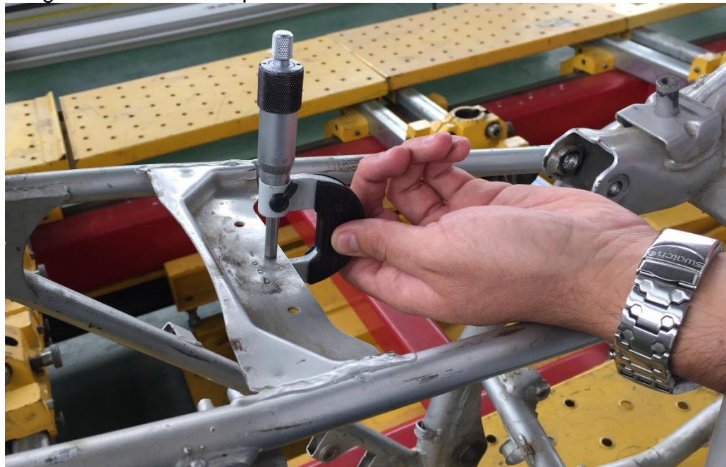
Imagen 43. Toma de espesores con micrómetro
