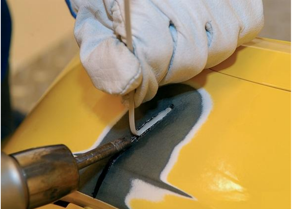
Imagen 30. Soldadura en plásticos
