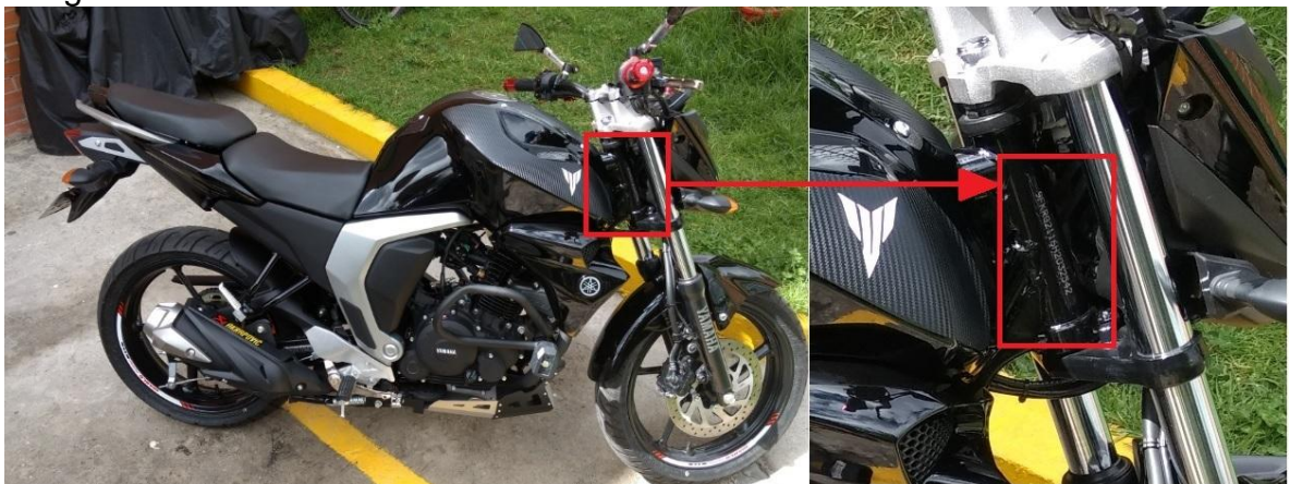
Imagen 10. Ubicación del número VIN en el cabezal de dirección
