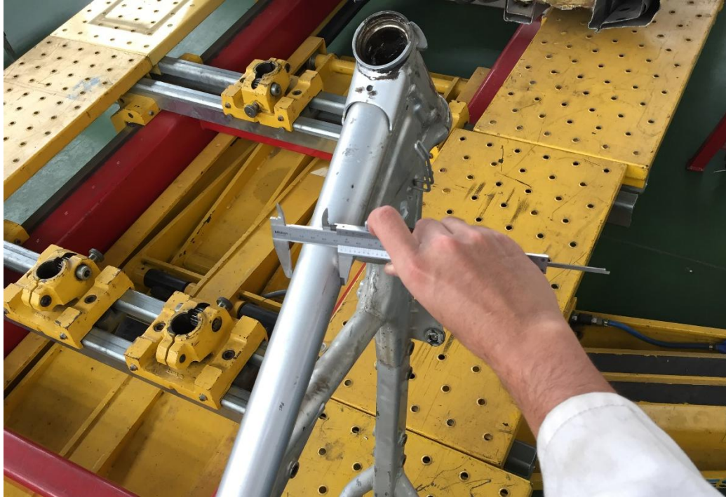
Imagen 44. Toma de medida de diámetros externos
