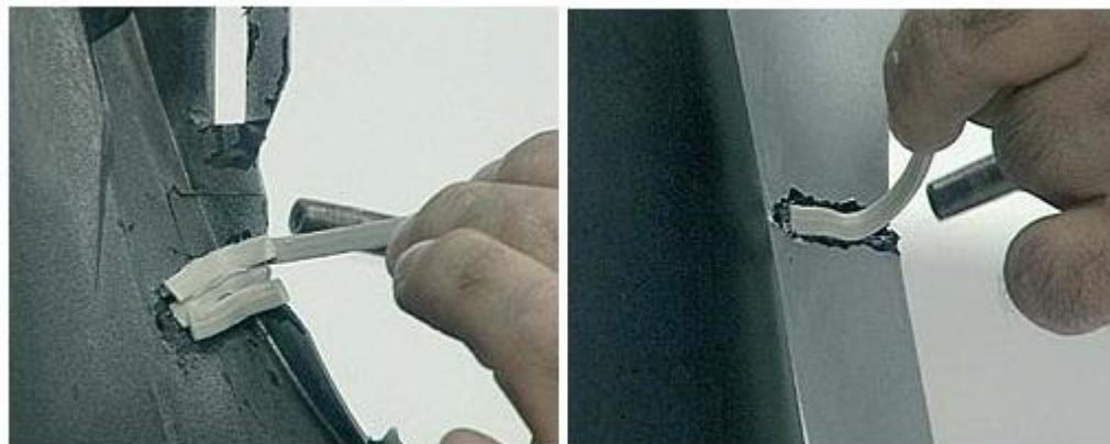
Imagen 26. Soldadura de termoplásticos
