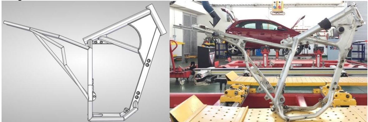
Imagen 50. Correlación entre modelo CAD y chasis real
