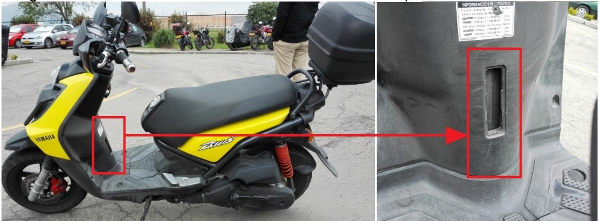
Imagen 12. Ubicación del número VIN en motocicletas tipo Scooter
