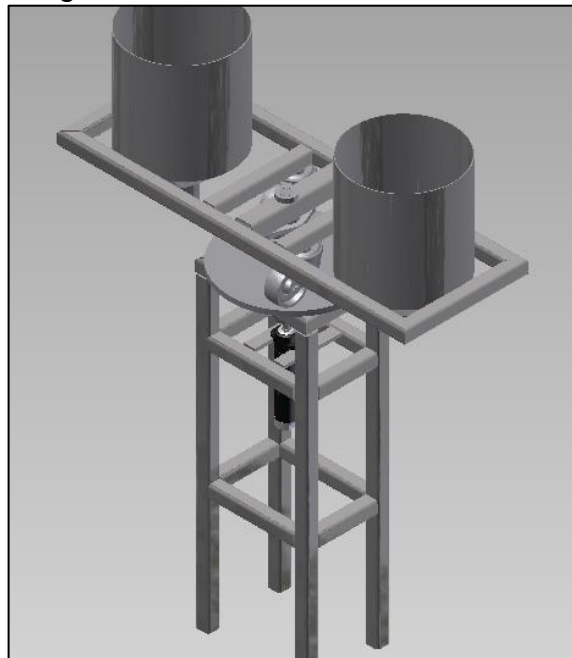
Imagen 43. Estructura intercambio tolvas
