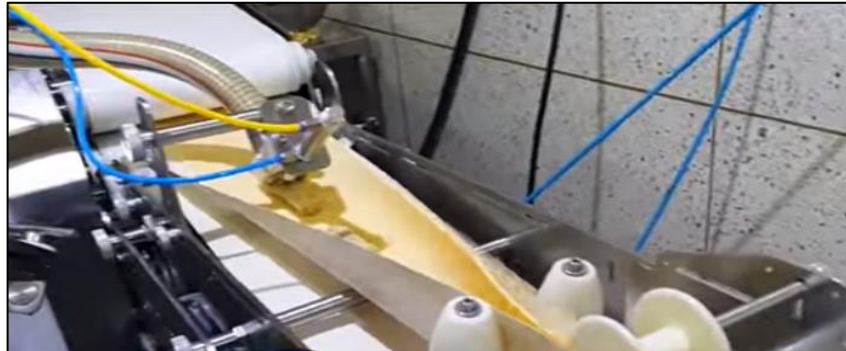
Imagen 6. Dosificador de relleno automático
