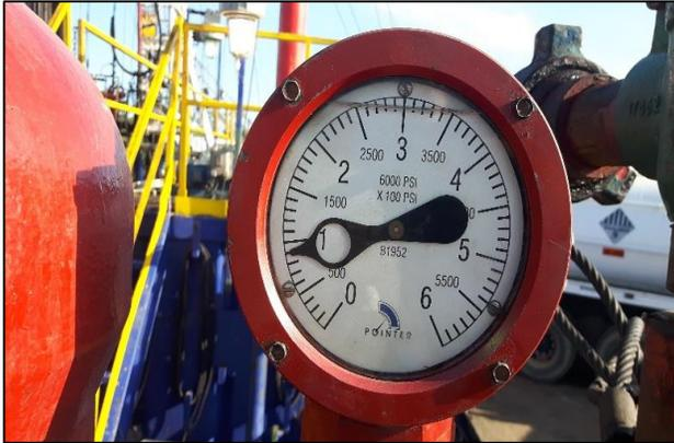
**Figura 51.** Presión para prueba de integridad 4.
