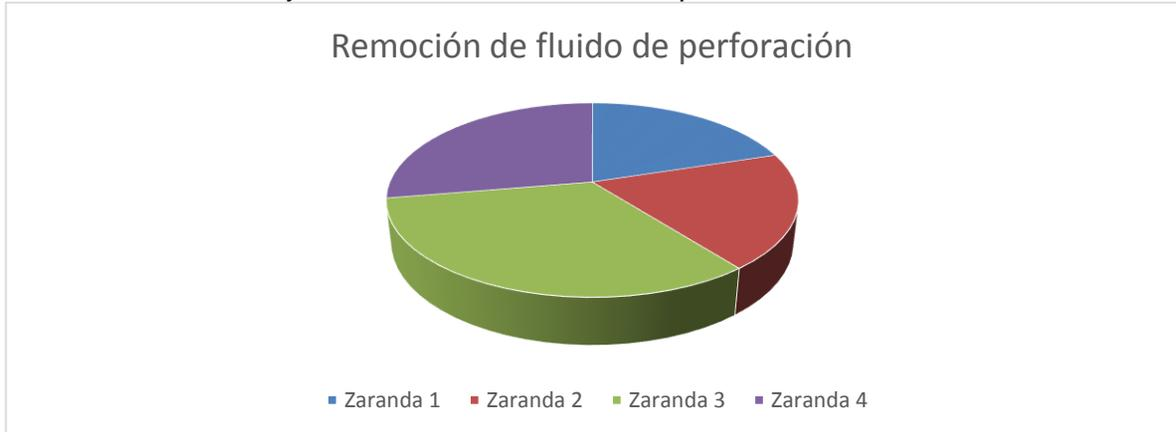
De acuerdo a los resultados obtenidos en la **Tabla 23**, y en la **Grafica 9**, el promedio de remoción de fluido de perforación de los cortes en los equipos con mallas planas (Zaranda 1 y Zaranda 2) es de 31.76%, mientras que para las zarandas 3 y zaranda 4 revestidas con mallas piramidales se tuvo un promedio de remoción de fluido de perforación de los cortes de 48.58%, habiendo un 16.82% de diferencia entre estos dos, lo cual representa una recuperación adicional de fluido de perforación.
