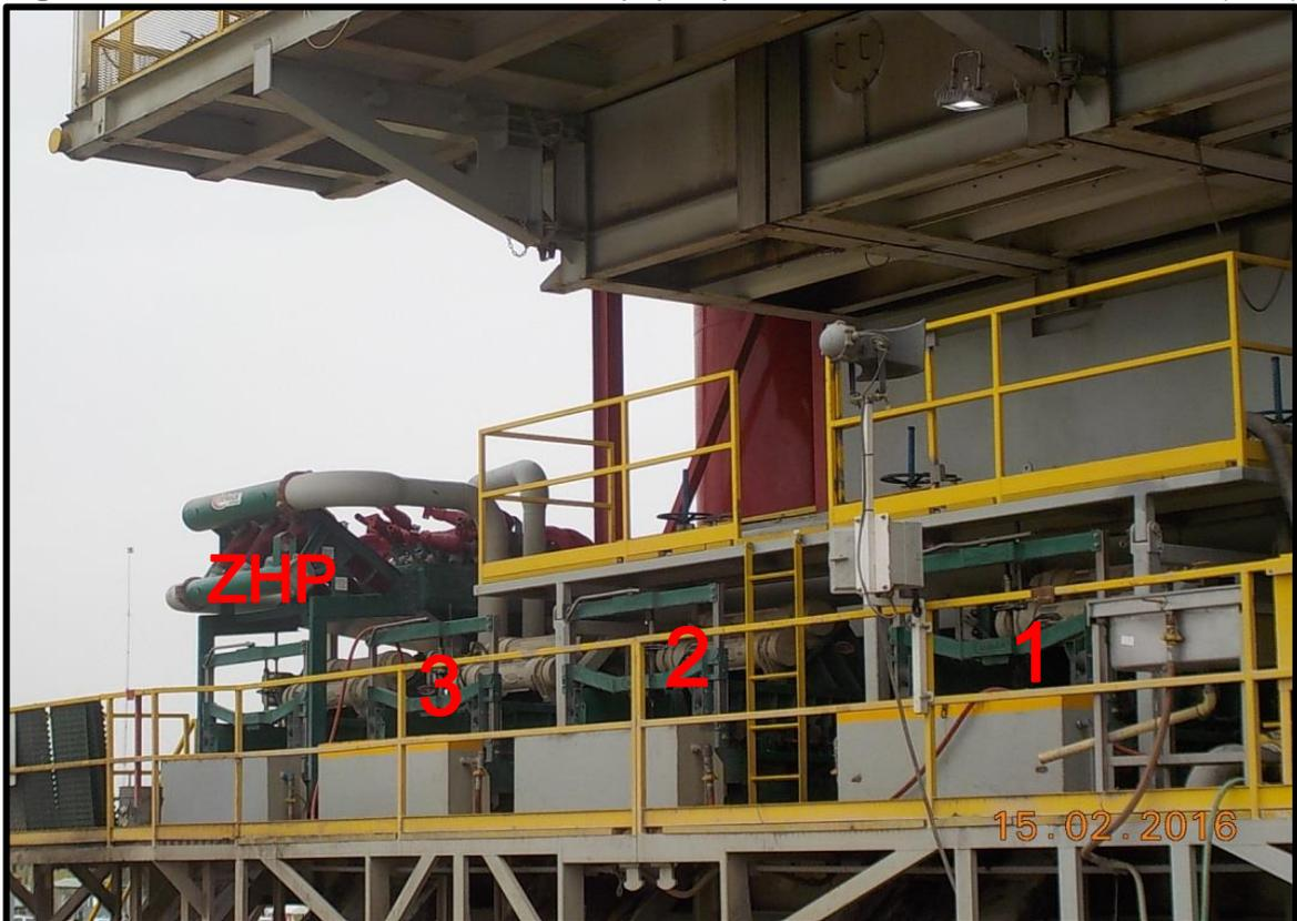
**Figura 7.** Orden de instalación de los equipos primarios de control de sólidos. (X42)
