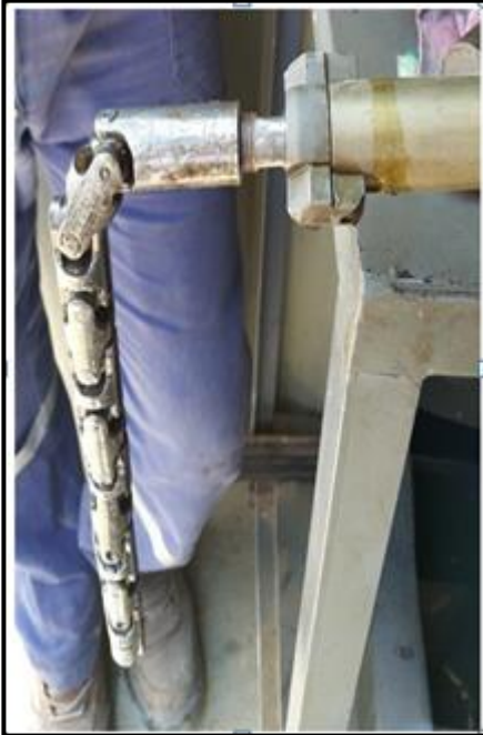
Imagen 8. Motor de fondo conectado al Flex Shaft.
