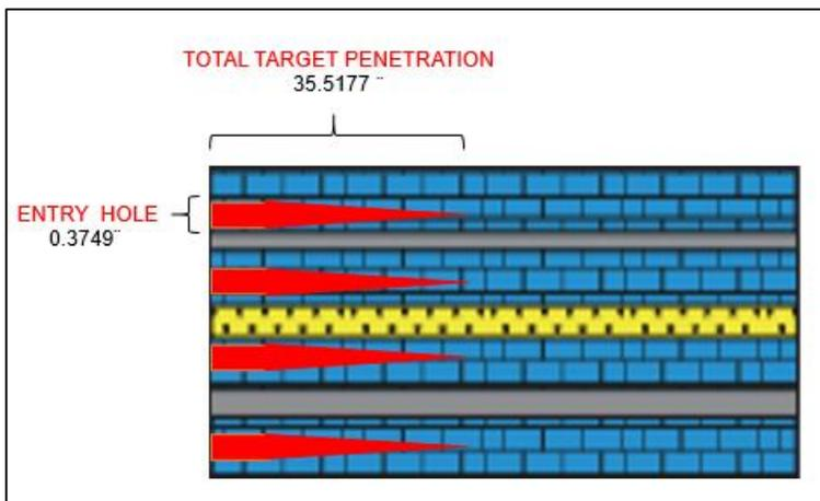
**Tabla 26.** Entry Hole y Longitud de Penetración para cada posición del Pozo HN-02
