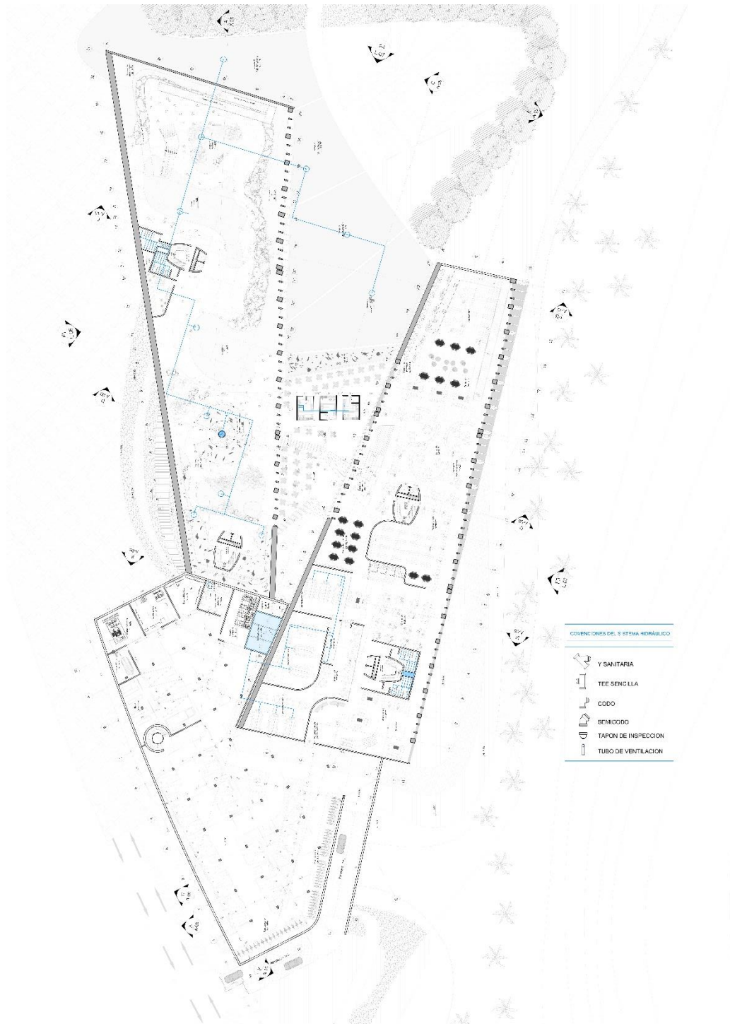
Plano 17. Red hidráulica sótano.
