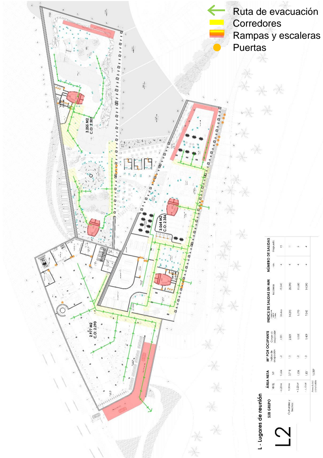
Plano 33. Evacuación Planta de Sótano
