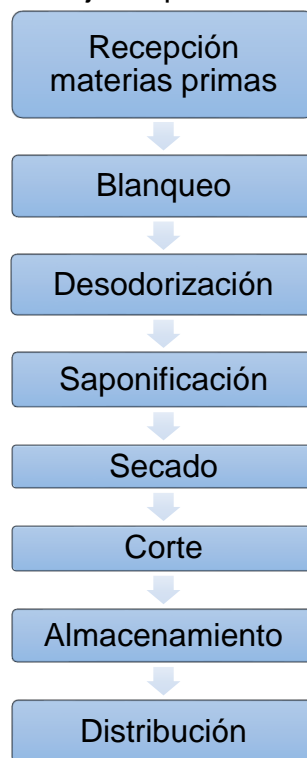
Imagen 1. Diagrama de flujo de proceso de fabricación de jabón
