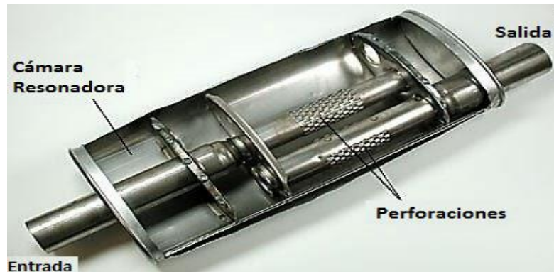
Imagen 2. Corte Transversal Silenciador
