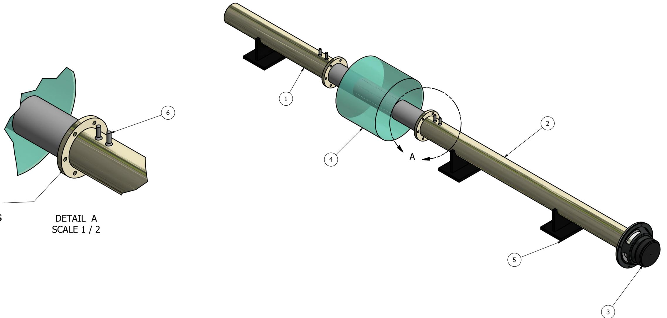
Sujeción de componentes por medio de bridas
