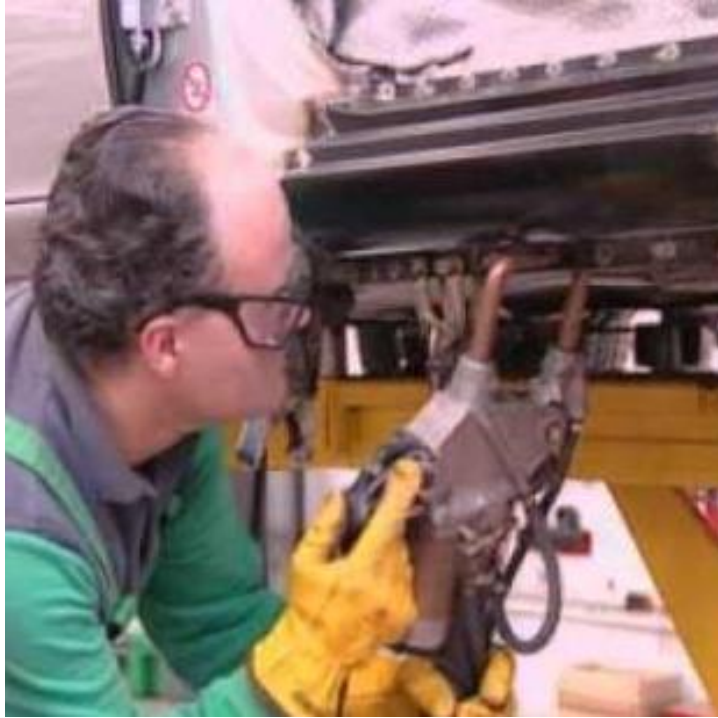
Figura 9. Soldadura por puntos de resistencia
