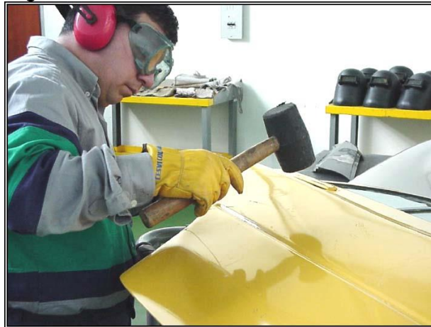
Figura 5. Recalcado de lámina
