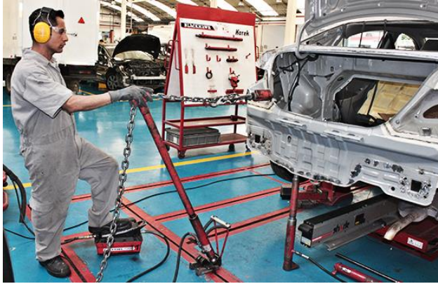
Figura 4. Estirado de carrocería
