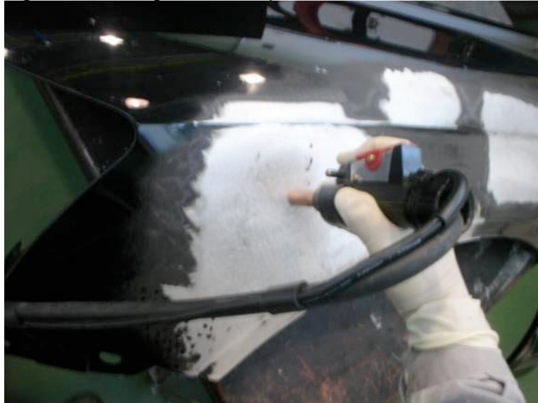
Figura 7. Recogida de chapa con electrodo de cobre
