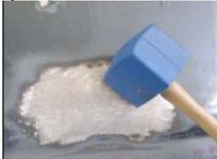
Figura 3. Aplanado de lámina con martillo
