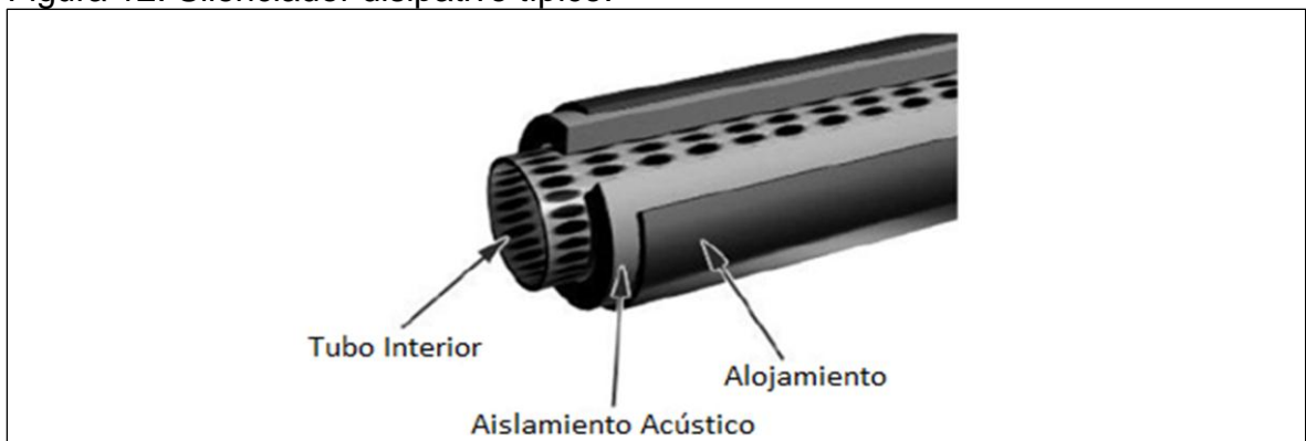
Figura 12. Silenciador disipativo típico.
