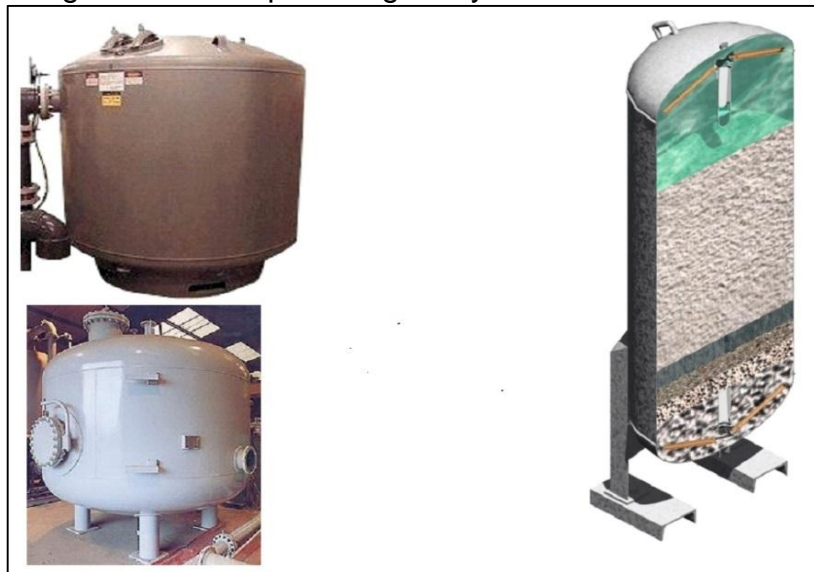
Imagen 7. Filtro rápido de grava y arena
