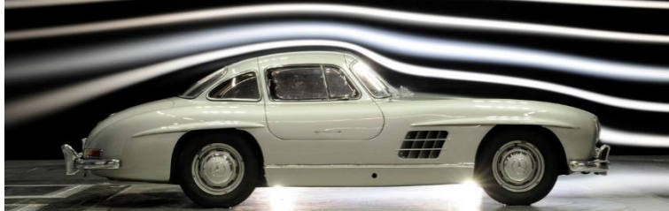
Figura 40. Prueba con humo en un túnel de viento
