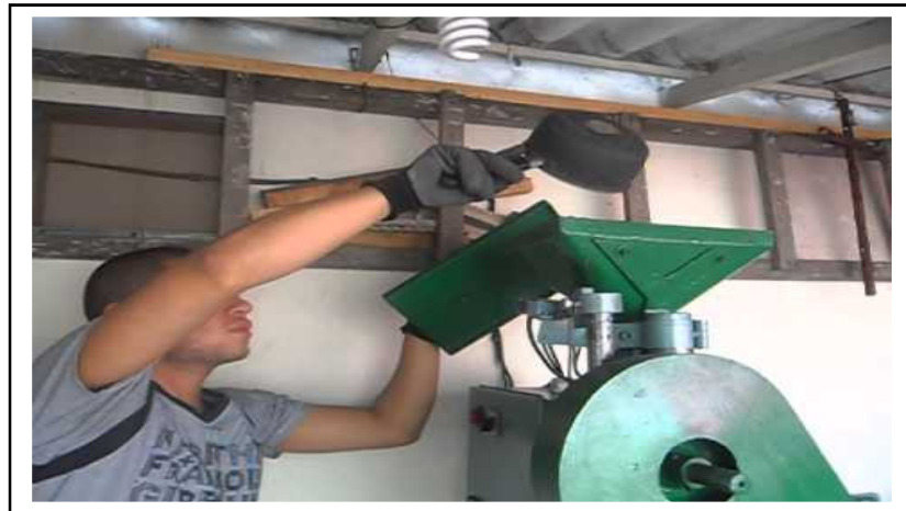
Imagen 101. Vaciado de la tolva
