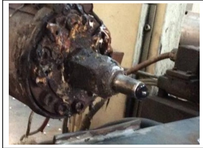
Imagen 102. Residuos de material en la boquilla
