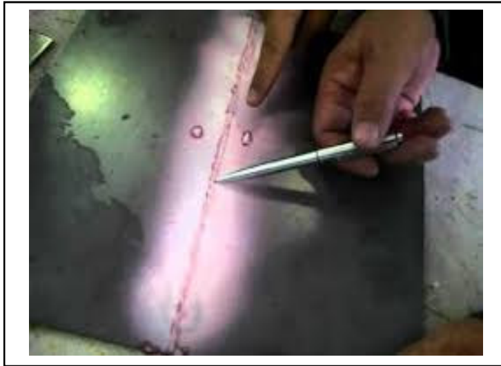
Imagen 104. Líquidos penetrantes en soldadura
