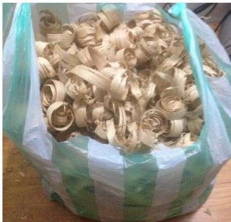
Paso seguido a la guadua escogida se pesa y se sumerge en agua destilada con el fin de eliminar impurezas, residuos y disminuir el pH llevándolo hasta que sea lo más cercano a un pH neutro a continuación de muestra en la figura 22 la fibra limpia y pesada.
