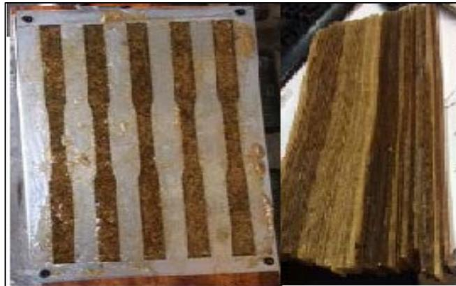
Se realizaron 5 probetas por cada formulación como se muestra en la tabla 8 a continuación. Se realizó un total de 110 probetas, con fines de ser sometidas a ensayo de tensión.
