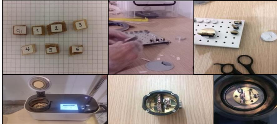
Seguidamente, como se observa en la Figura 33, se procede a realizar el montaje en el microscopio para iniciar su análisis fijando parámetros como su profundidad de campo.
