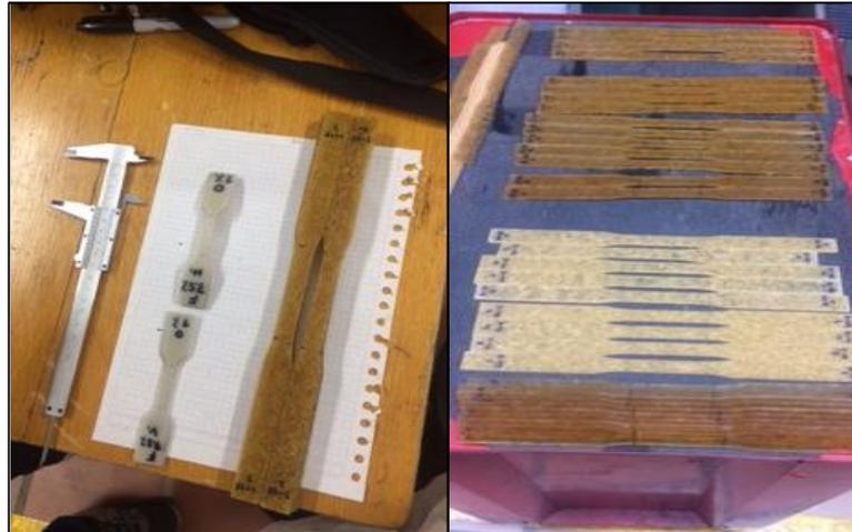
Seguidamente se procedió a estandarizar los parámetros de ensayo según la norma ASTM D638 como lo es la velocidad de ensayo, posicionamiento de las probetas y mordazas, verificación del software y toma de datos, se realizaron pruebas piloto las cuales permitieron una estandarización y optimización de los procesos.
