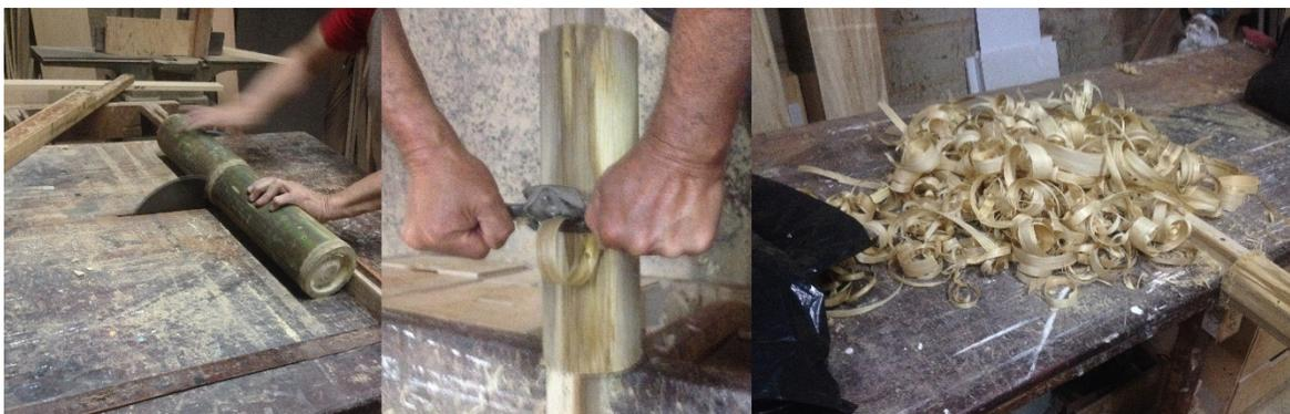
Seguidamente se realiza la separación de las fibras seleccionando las mejores fibras resultantes del proceso de cepillado con el fin de obtener menos variaciones en el proceso de des-lignificación. La Figura 21 muestra la fibra seleccionada para el proceso.
