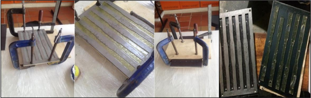
Finalmente, se realiza el proceso de desmolde donde se retiran las impurezas resultantes en el molde, placa de apoyo y probetas, inmediatamente se procede a realizar el proceso de encerado de las placas y se repite el proceso, en la figura 25 se muestra las probetas ya secas para desmoldar, y probetas ya desmoldadas.
