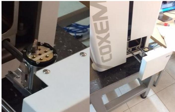
Dando inicio a su funcionamiento se procede a realizar la búsqueda del sector a visualizar en este caso la fibra fijando parámetros como su contraste, enfoque, desplazamiento, brillo, gamma y aumento desde su software como se muestra en la figura 34.
