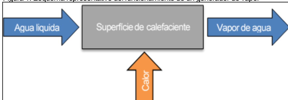
Figura 1. Esquema representativo del funcionamiento de un generador de vapor
