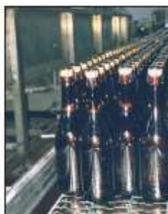
uni SS 881 TAB-K325 Giro lateral Botellas de cerveza 3 líneas Lubricante: Agua con jabón
