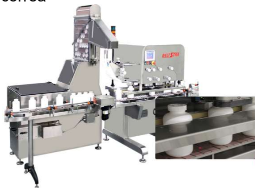
Imagen 9. Sistema de tapado en línea accionado por correa
