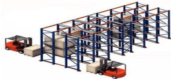
Figura 27. Ejemplo de almacenamiento de doble profundidad
