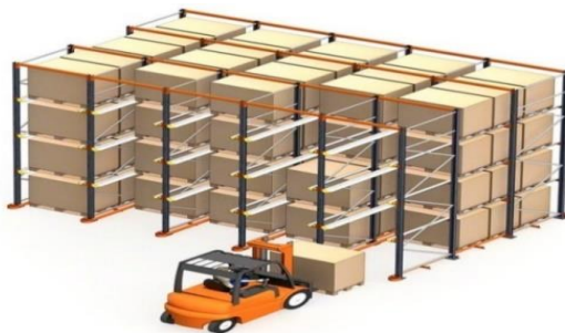
Figura 28. Ejemplo de almacenamiento Compacto
