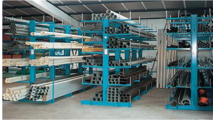
Figura 31. Ejemplo de Almacenamiento en Cantiléver
