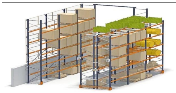
Figura 26. Ejemplo de almacenamiento selectivo
