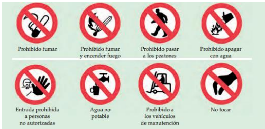
Imagen 29. Señales de prohibición
