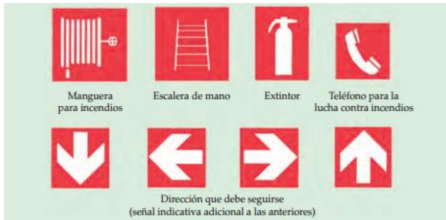
Imagen 31. Señales de equipos de lucha contra incendios
