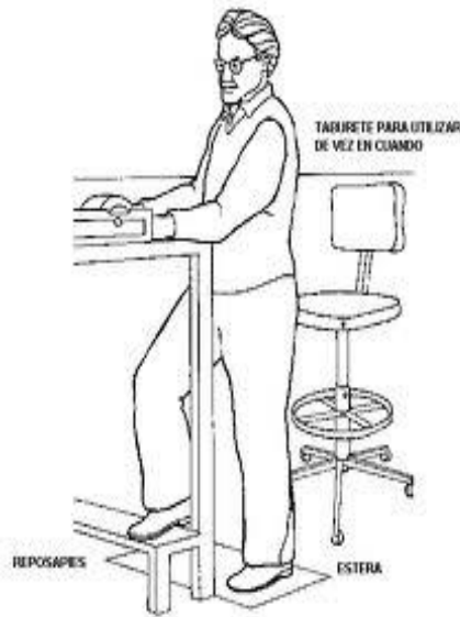
Ilustración 34. Trabajos de pie
