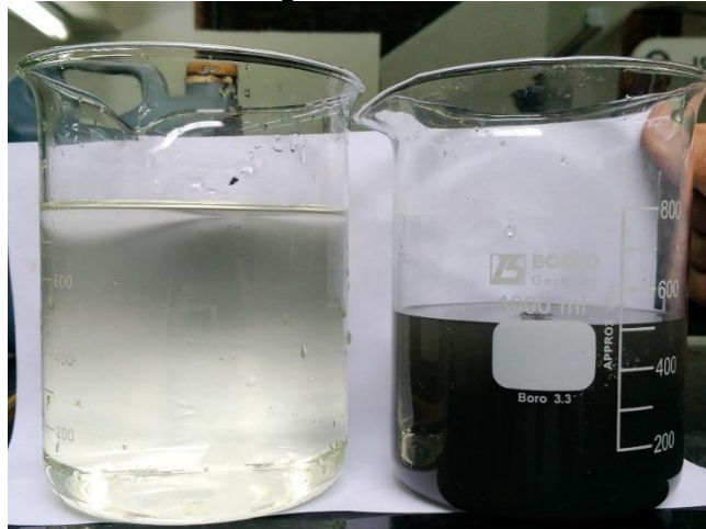
Imagen 16. Comparación agua tratada y filtrada frente al agua cruda
