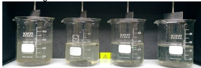
Imagen 14. Uso de Policloruro de Aluminio como coagulante
