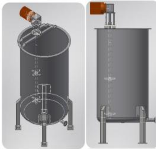
Figura 34. Tanque de agitación.
