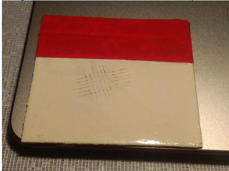
Figura 16. Lámina con la cuadrícula después de la prueba.
