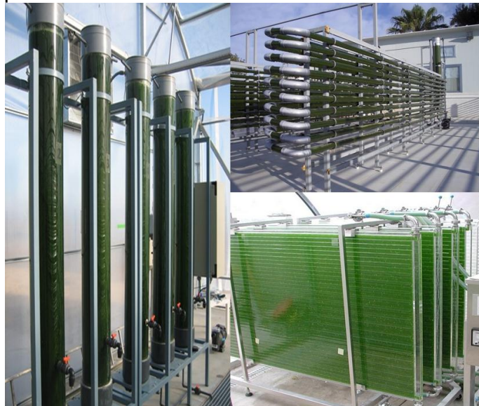
Figura 3. Fotobiorreactor de columna, fotobiorreactor tubular y fotobiorreactor de pared plana
