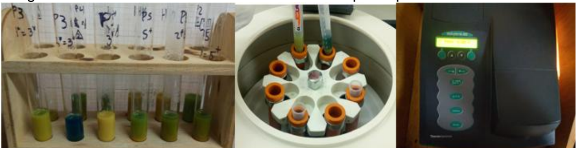
Imagen 16. Determinación de azúcares residuales por espectrofotómetro
