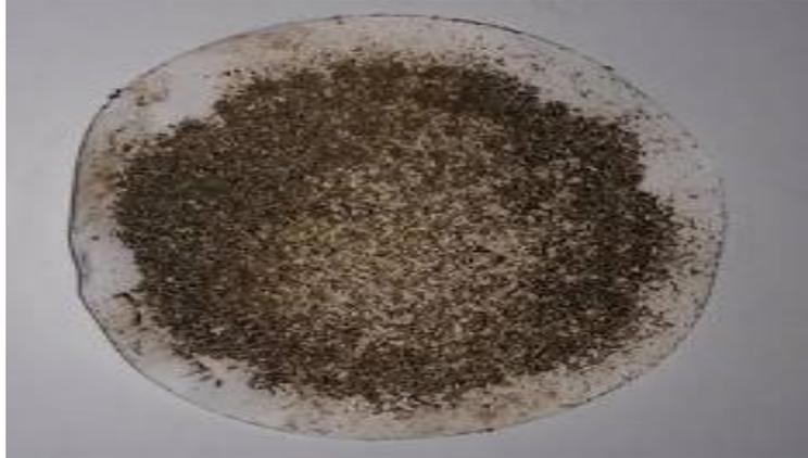
**4.2.3.2 Lignina soluble en ácido.** Después del proceso de hidrólisis ácida y filtrado, el hidrolizado obtenido mostrado en la imagen 11, es sometido al análisis de lignina soluble, a través de mediciones de absorbancia utilizando una longitud de onda de 205nm en el espectrofotómetro.
