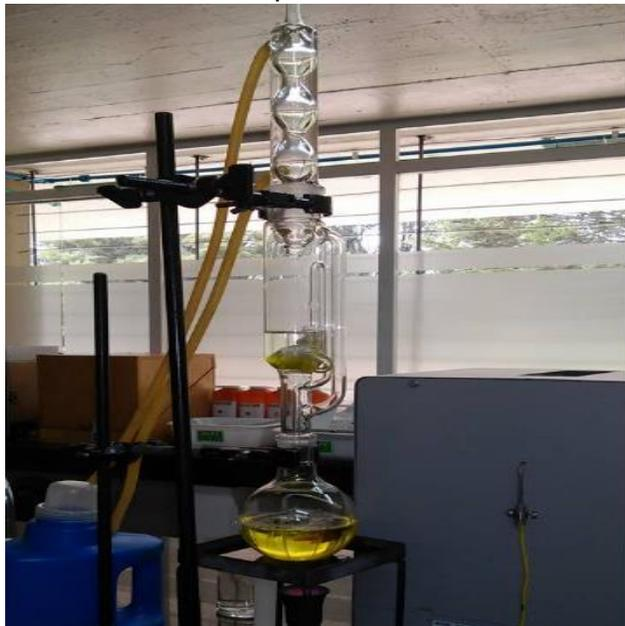
El peso de la muestra libre de extraíbles sin secar fue de 6,9765 g, se secó en un total de 4 horas, pesando cada hora hasta obtener peso constante.
