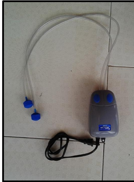
Figura 9. Sistema de difusión de aire para el reactor.
