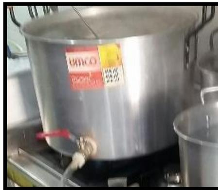
El tiempo de cocción varía entre 60 y 90 minutos a medida que el mosto se aproxima al punto de ebullición (temperatura entre 92 y 93 °C a presión de 560 mm Hg), se va formando una capa espesa de aspecto cremoso y color marrón como se observa en la Figura 18, las cuales son partículas de cereales arrastradas a la superficie que deben ser retiradas mediante el uso de un colador, llamado en la industria cervecera como desempumado.
