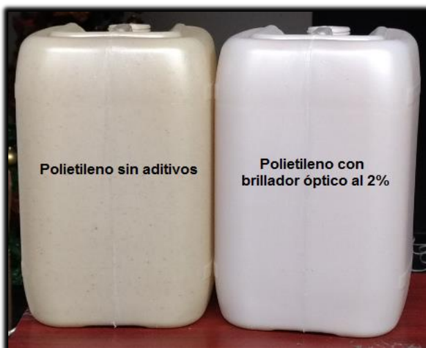
Figura 31. Comparación de color con la aplicación del aditivo brillador óptico
