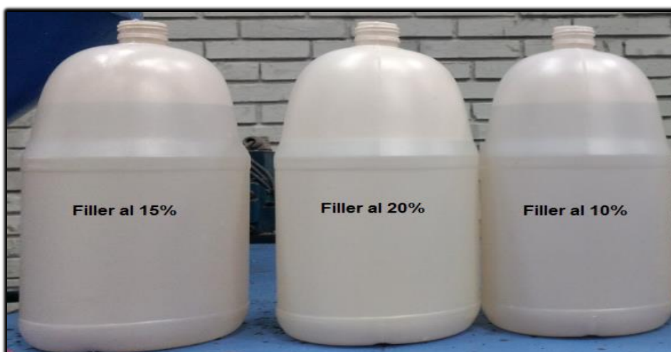
Figura 34. Translucidez de envases con Filler
