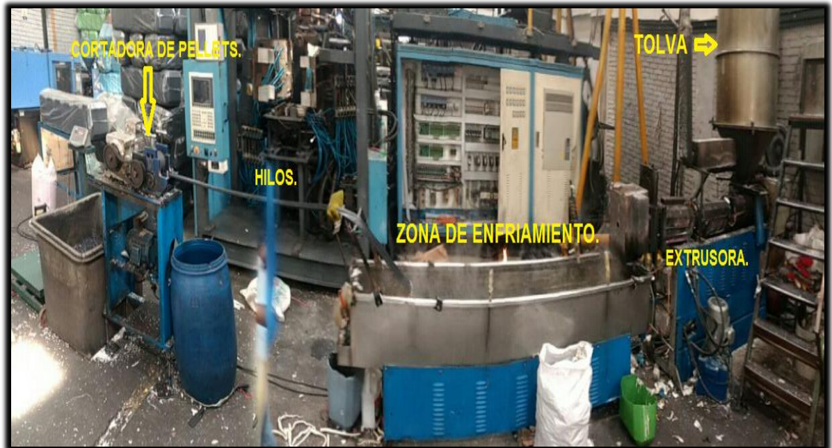
Figura 1. Zonas de la peletizadora de COLFOPLAS S.A
