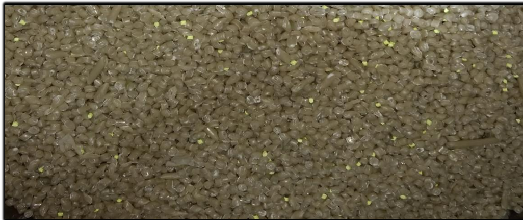
Figura 30. Dosificación al 2% de brillador óptico
