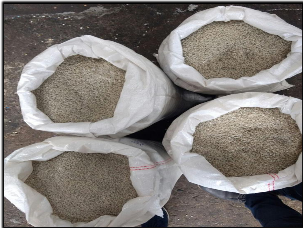
Figura 18. Polietileno translúcido recuperado con el mismo grado de contaminación
