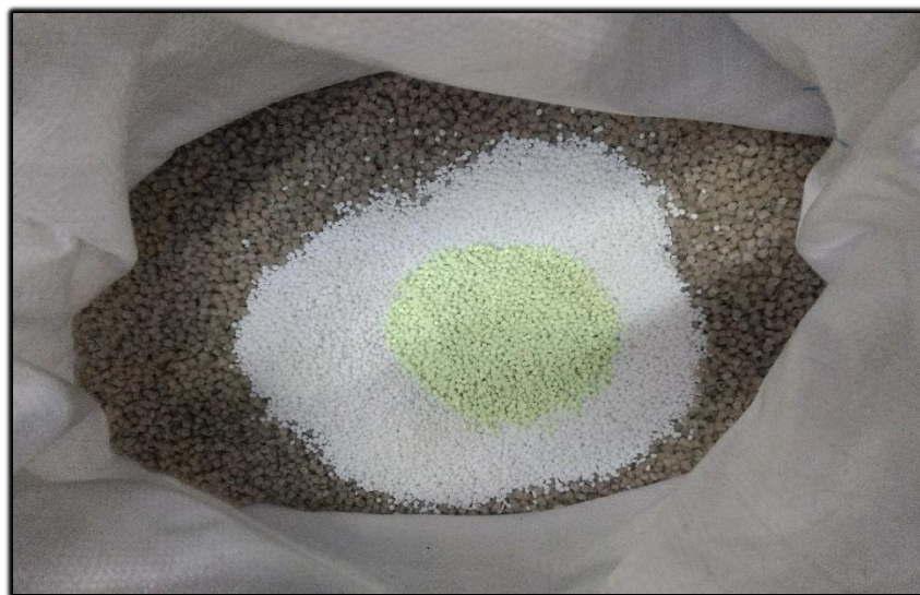
Figura 35. Adición de aditivos filler y brillador óptico para el diseño de experimentos 3^2 .
