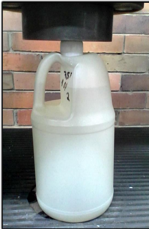
Figura 25. Ensayo de compresión a envase medio galón
