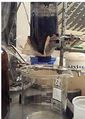
Se procedió a verter las dos muestras por este filtro de carbón activado en donde desapareció el olor fuerte y penetrante en su totalidad ya no se percibía ningún tipo de contaminación en el agua, finalizadas las operaciones unitarias seleccionadas para evaluar a nivel laboratorio en este proyecto; se analiza uno de los parámetros críticos en este estudio (DQO), en donde se obtuvieron los resultados de la tabla 26.
