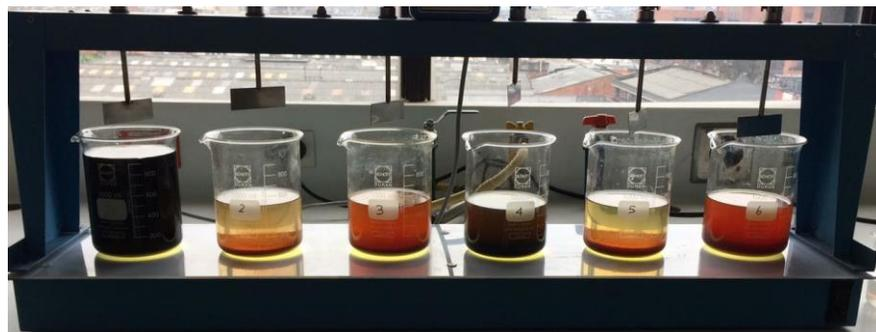
Se observa, que en la jarra número 2 y 5 el agua es más clara corroborando que es la dosis con mejor respuesta al reactivo. Al tener el agua con un pH adecuado para realizar el proceso coagulación-floculación (figura 16), se realiza la adición de cloruro férrico al 3% y sulfato de aluminio al 5% el cual actuará como floculante en
