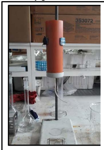
En esta alternativa se realizó un toma de muestra de agua residual después de realizar el proceso de coagulación-floculación, pasando la muestra por un filtro que contenía carbón activado y gravilla dentro de un cilindro con una boquilla que permitía el paso del agua para su respectiva clarificación, sin embargo este proceso tarda aproximadamente 1 hora por cada muestra correspondiente a 500 ml.
