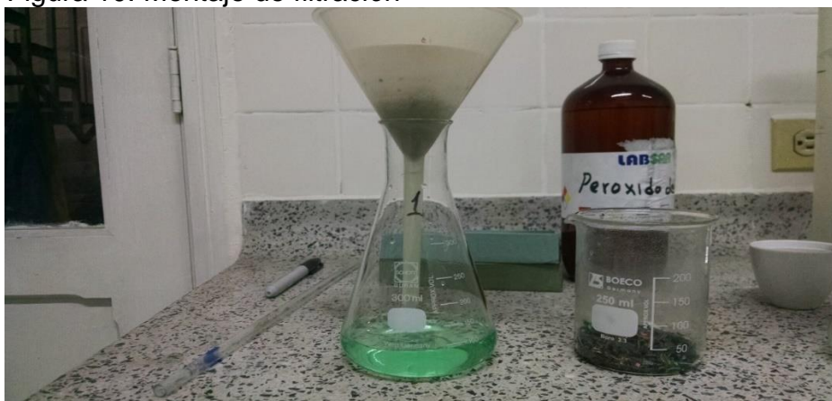
Figura 10. Montaje de filtración
