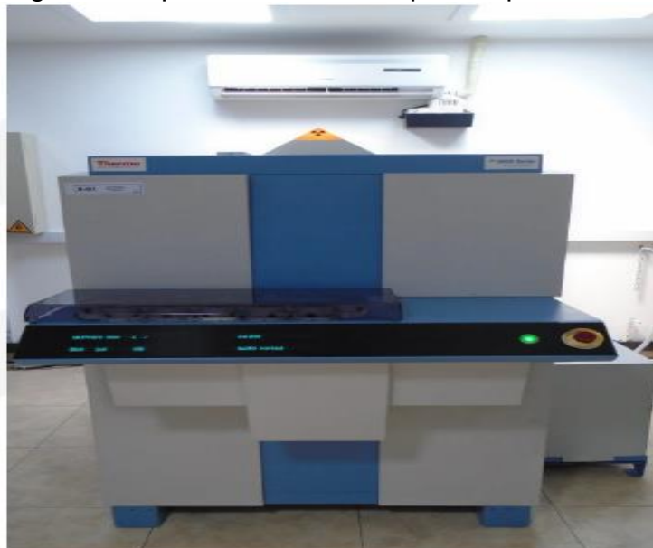
Figura 6. Espectrómetro usado para la prueba de XRF
