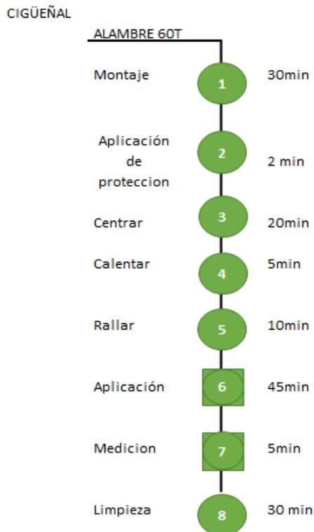
**2.2.4.3 Diagrama de operaciones de soldadura actual.** Se presenta las operaciones e inspecciones que tiene el proceso de soldadura en el diagrama 4.
