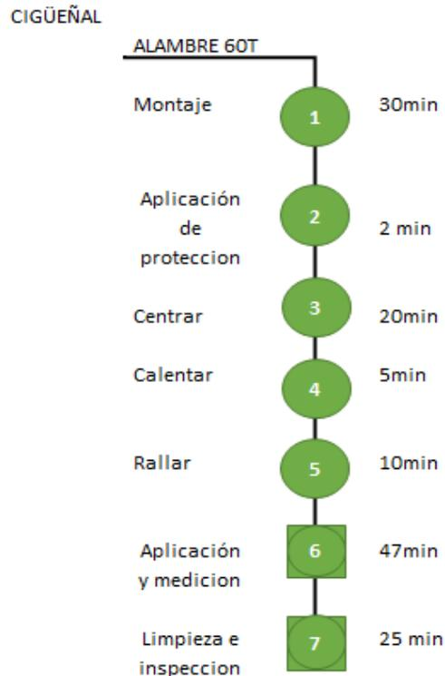
**2.2.4.7 Diagrama de operaciones de soldadura propuesto.** A continuación se expone el diagrama propuesto con el fin de que el proceso de soldadura tenga un mejor desempeño.
