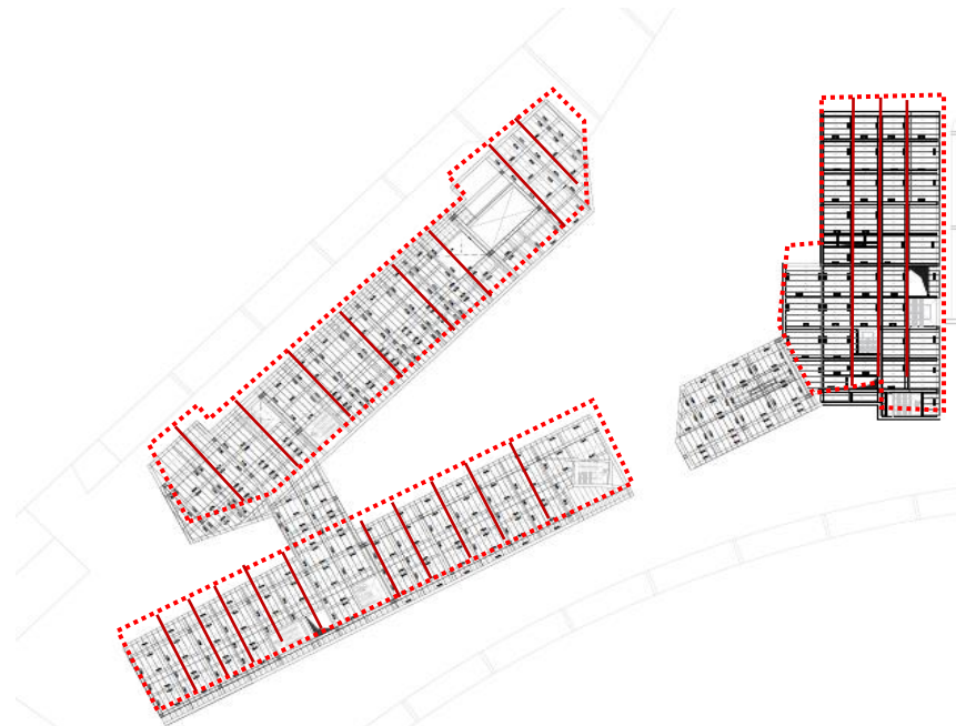
Imagen 78. Modulaci3n y juntas de dilataci3n
