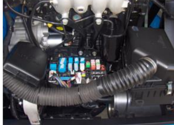
VISTA DE CAJA DE FUSIBLES EXTERNA
