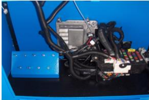
VISTA INTERNA DE CAJA DE FALLAS Y DE LAS CONEXIONES DENTRO DE CAJA DE CONTROL
