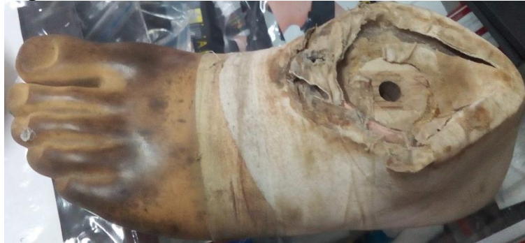
Figura 52. Pie SACH deteriorado.
