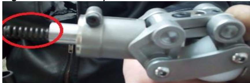
Figura 58. Rodilla de 2 ejes con su resorte visible.
