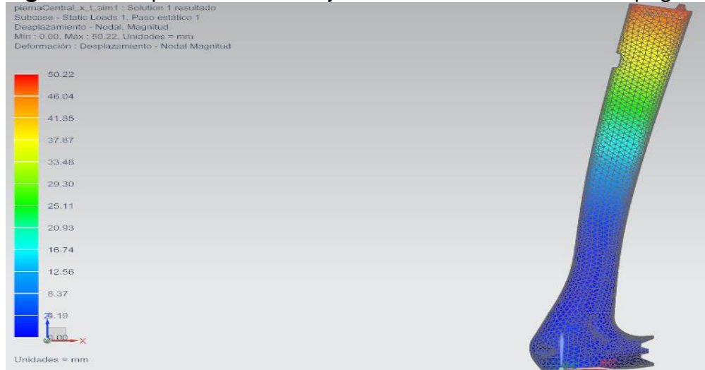
Figura 76. Desplazamiento del eje central en la subfase de despegue.
