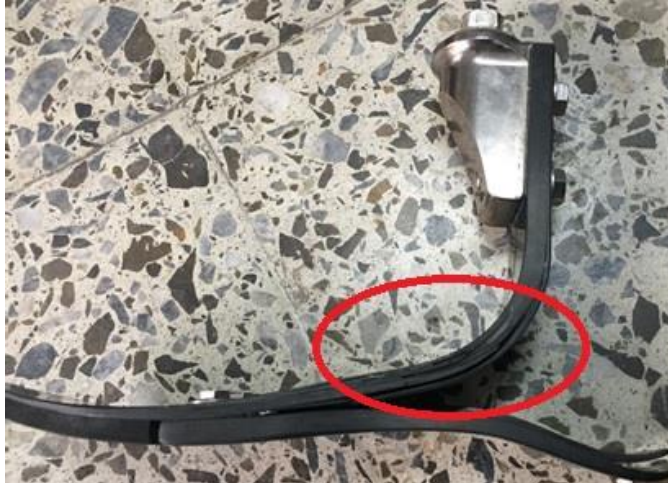
Figura 56. Pie STEN deteriorado.
