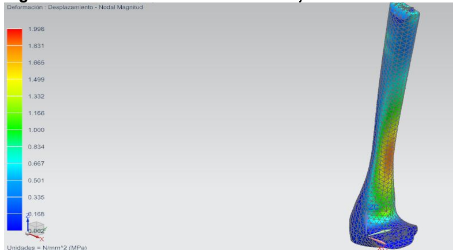
Figura 73. Esfuerzo elemental nodal del eje central.
