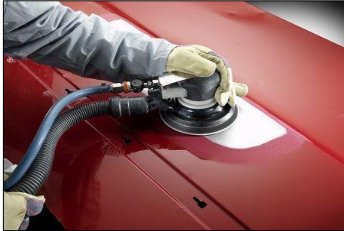
Figura 15. Lijado de masillas y aparejos
