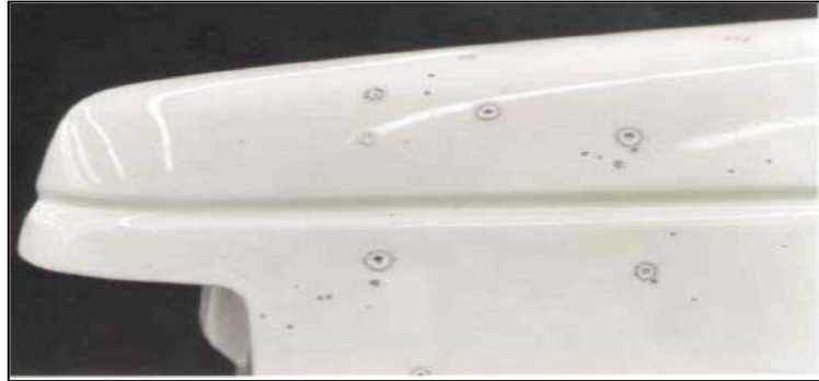
Figura 28. Defecto ojo de pescado
