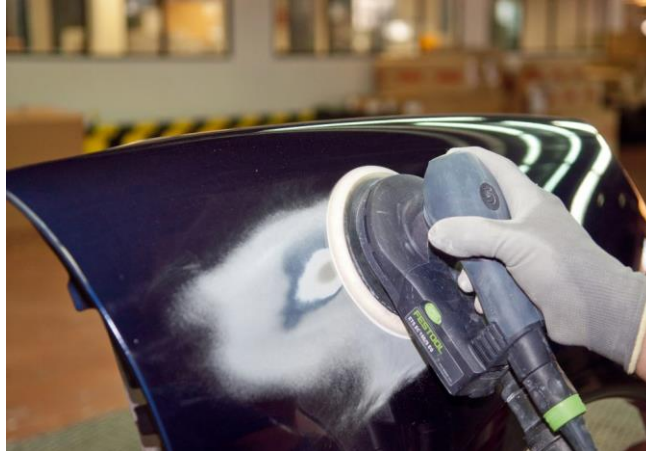
Figura 14. Máquina roto-dinámica para lijado
