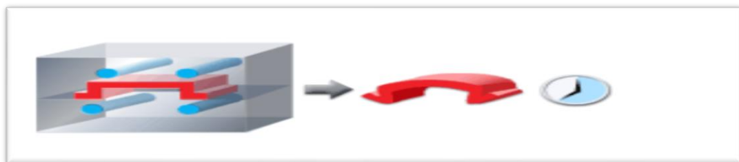
Figura 44. Deformidades por mala refrigeración
