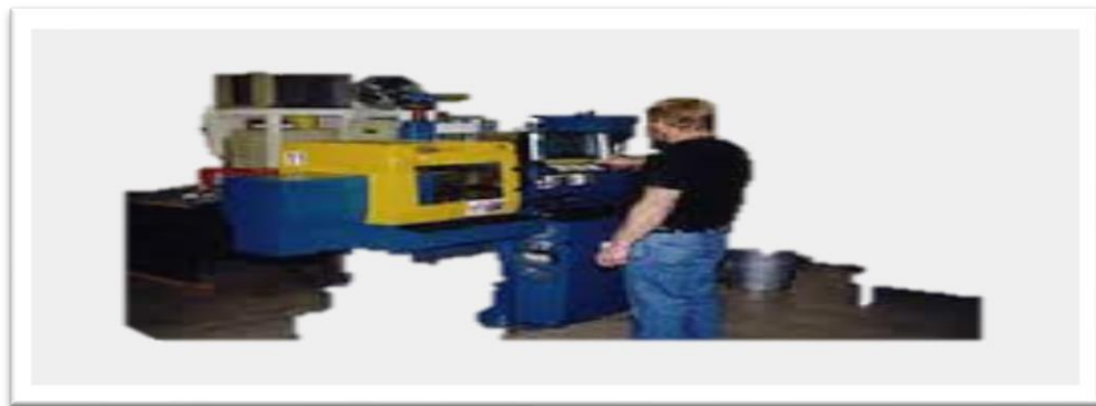
Figura 71. Verificación de capacidad de la máquina inyectora
