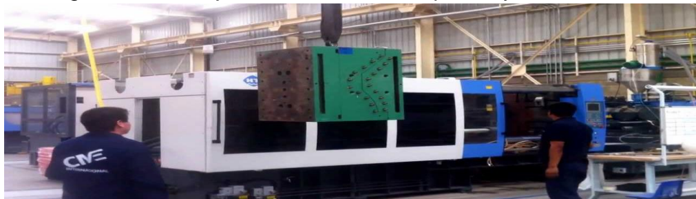
Figura 72. Montaje del molde en la máquina inyectora
