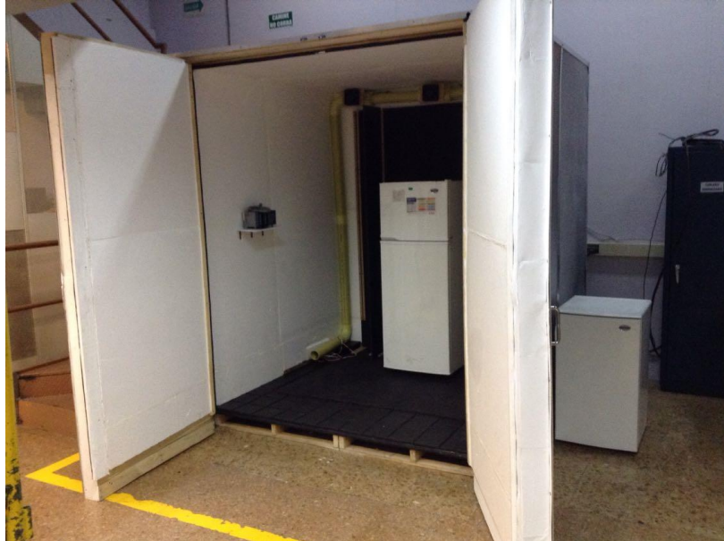
Figura 4. Laboratorio para pruebas y ensayos energéticos para equipos de refrigeración doméstica.
