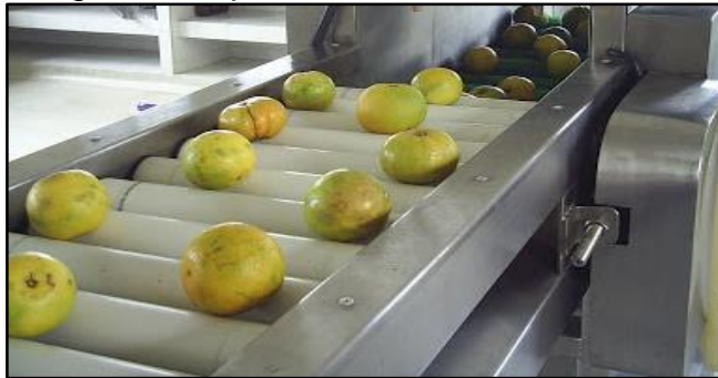
Imagen 8. Representación método de rodillos
