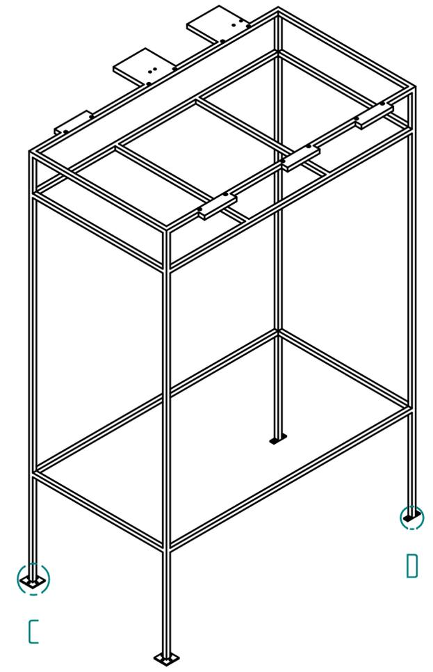
NOTA: LA ESTRUCTURA TIENE UN PERFIL CUADRADO HUECO 15 X15 X 0,9 MM
