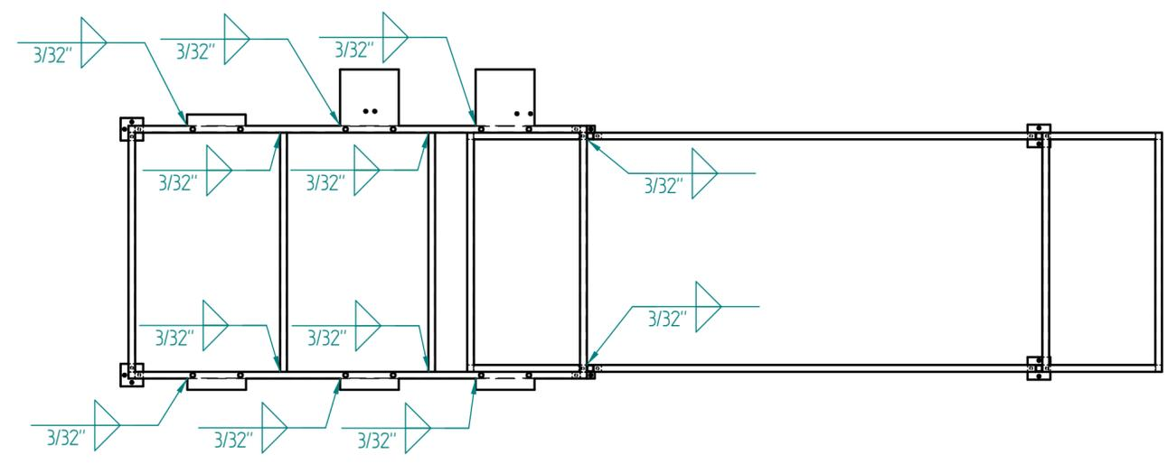
NOTA: TODAS LAS SOLDADURAS UTILIZAN UN ELECTRODO E6010
