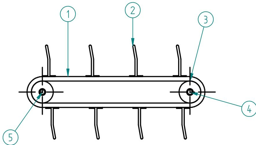
NOTA: EL EJE LARGO SE ACOPLA A LOS DOS MOTORES, EL DE LA BANDA Y EL DISTRIBUIDOR
