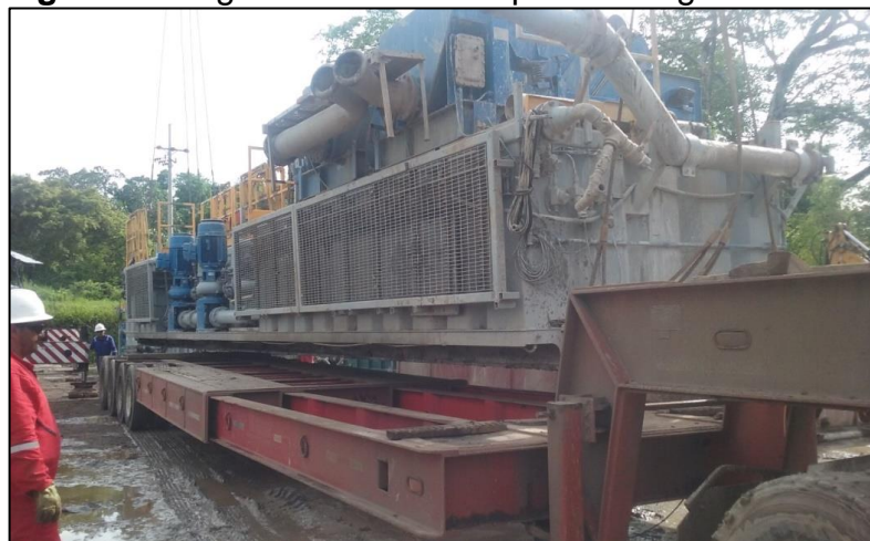
Figura 22. Rig Down de los tanques del Rig 50.
