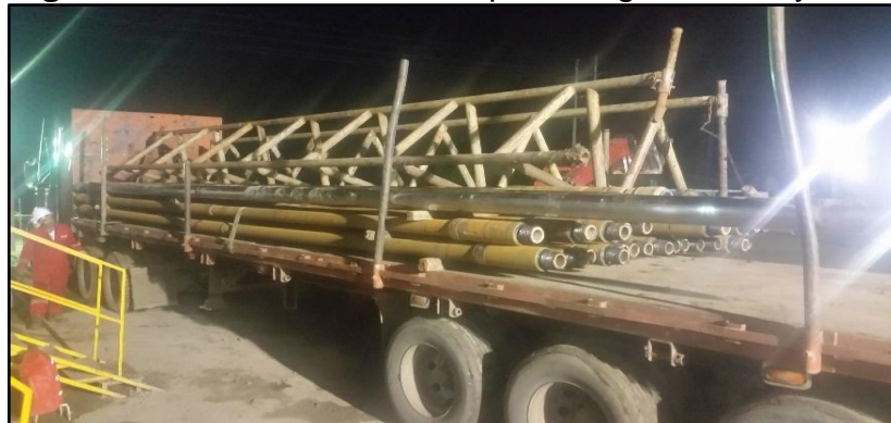
Figura 16. Cama alta utilizada para cargar tubería y racks
