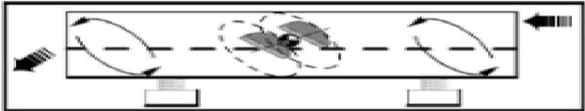
Figura 17 Movimiento elíptico simétrico de la canasta.
